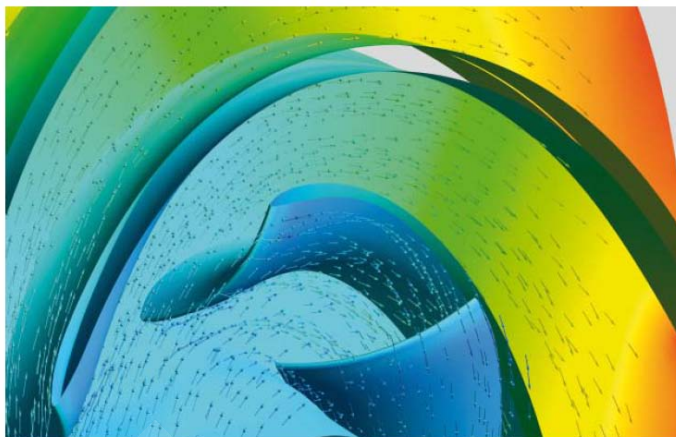
CFD软件分析出的叶轮内部流体速度矢量图
